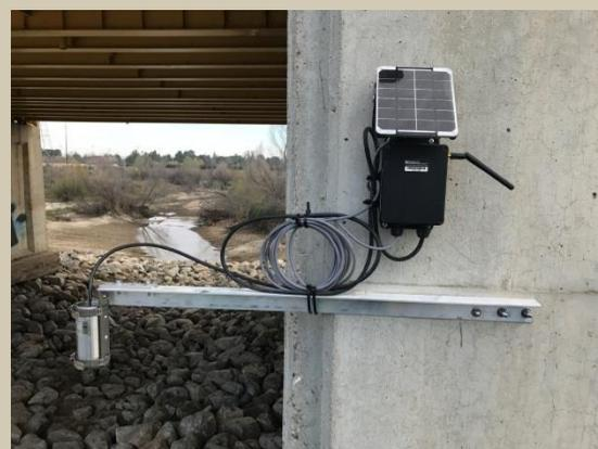
Compteur de niveau d'eau à ultrasons de SenSpot™
